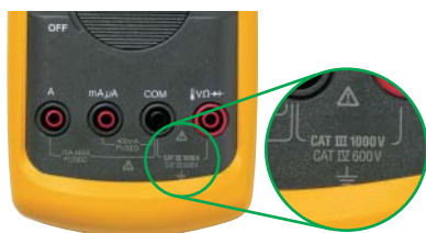
Используйте измерительные приборы со следующей маркировкой: 1000 В категории III или 600 В категории IV
