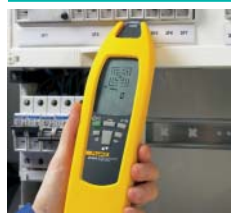
Определение местонахождения предохранителей/прерывателей и привязка к цепям
