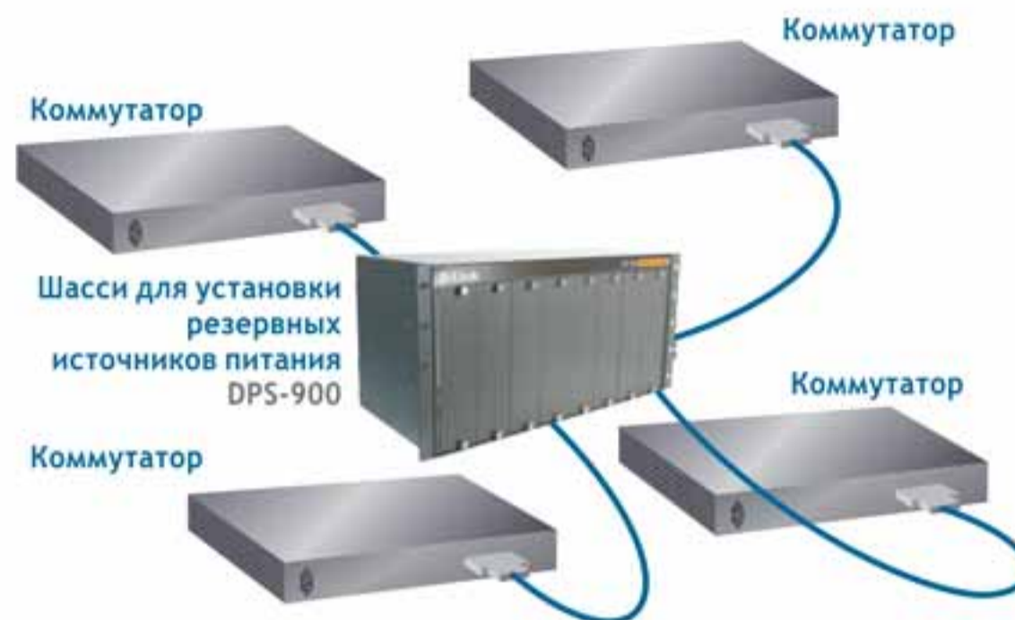
Подключение коммутаторов D-Link к резервному источнику питания Шасси DPS-900 предназначено для подключения к резервному питанию до 8 коммутаторов
